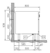
Electrical inlet (power) EQ Equipotential screw
